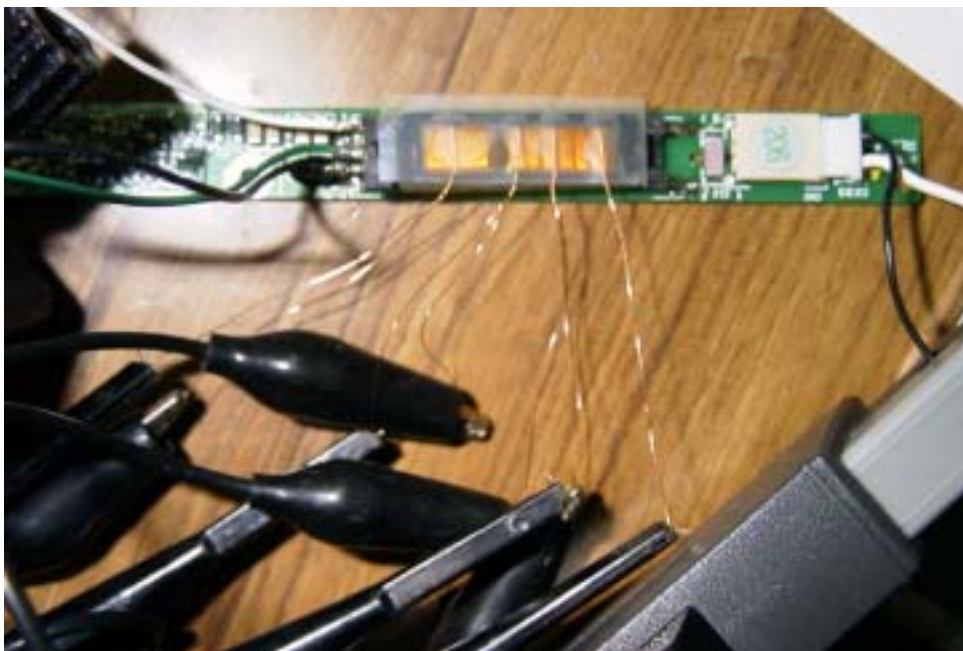
写真5 実測風景、各、磁束検出コイルに発生する電圧を測定する
